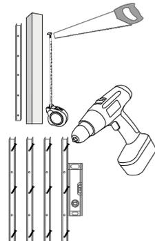
2. Определите расстояние между рейками (по стандарту расстояние между рейками равняется ширине выбранной модели рейки). В этом случае для Миланы и Ривьеры расстояние между монтажными планками - 47мм., для Брионы - 67 мм.
