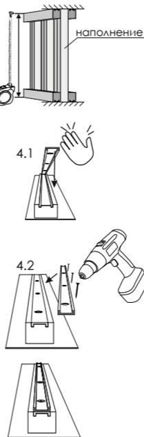
6. Для основания перегородки защелкните одну рейку на потолок и одну противоположно на полу на монтажную планку (пункт 3). Для монтажа на потолке дополнительно используйте клей.
