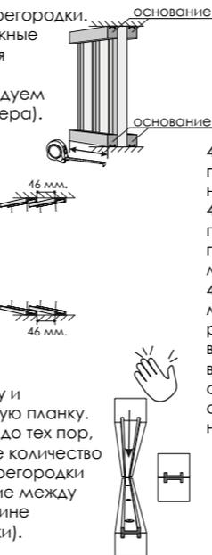
2. Определите высоту перегородки, определитесь с наполнением перегородки (Бриона, Милана, Ривьера) отрежьте рейки и монтажные планки нужной длины.
