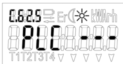
! B A ≠ ~ Рис. 6-1 PLC статус "PLC ---"
