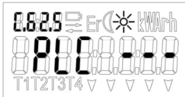
! B A ≠ ~ Рис. 6-1 PLC статус "PLC ---"
