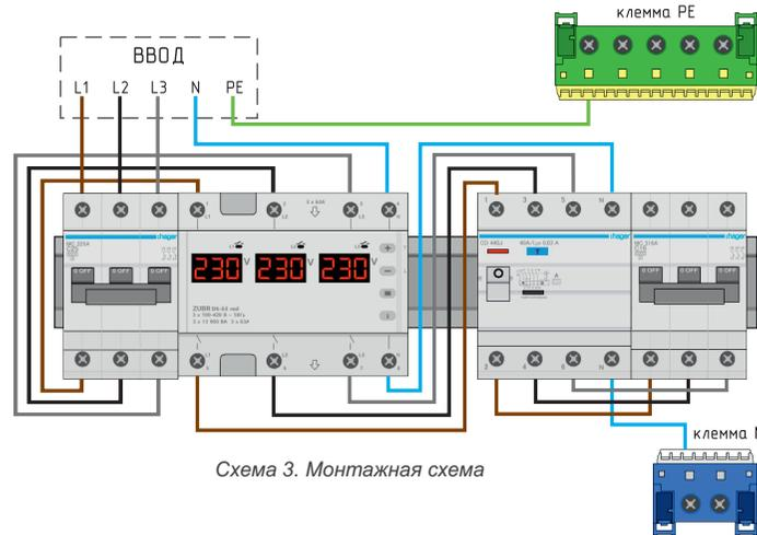
Схема 3. Монтажная схема
