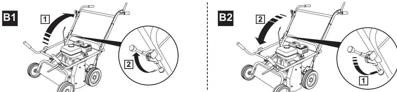
**B1** *Position travail - Posición trabajo - Position when in use - Arbeitsstellung - Posição de trabalho - Posizione lavoro - Pozycja robocza - Çalışma konumu - Θέση εργασίας - Рабочее положение*
