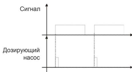
**B.** Cyclic Dosing (циклическое дозирование): насос дозирует циклически, пока присутствует внешний сигнал.
