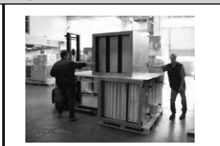
перемещение секции на поддон
