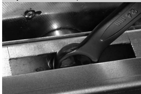
Рисунок 8 – Осевой болт отпустить ключом №24
