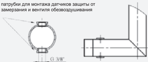
Рис. 12 – монтажа датчиков защиты от замерзания
