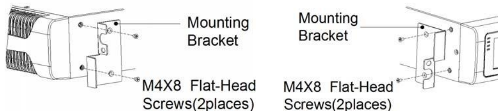
Мал.5 Встановлення монтажних кронштейнів
