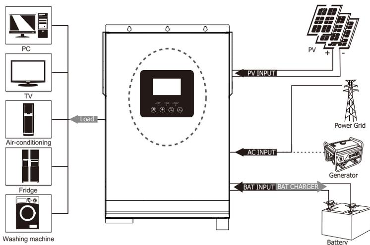
Рис. 1 Гибридная система электроснабжения
