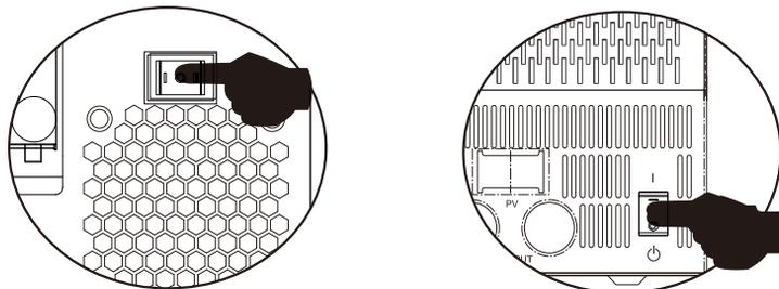
После правильной установки устройства и правильного подключения батарей просто нажмите переключатель On / Off (расположен на нижней части корпуса), чтобы включить устройство.
