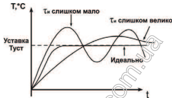
Рисунок 3.9 График работы интегрального регулятора.
