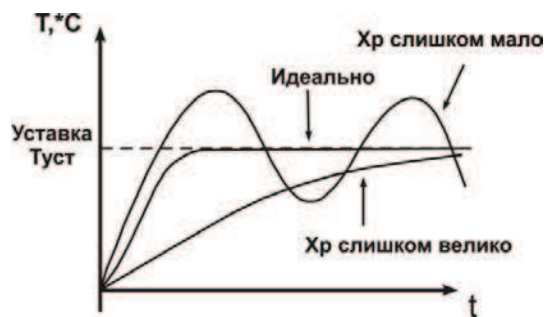
Рисунок 3.8 График работы пропорционального регулятора
