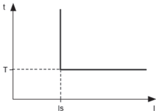
Рисунок 1.2 - Принцип защиты с независимой выдержкой времени
