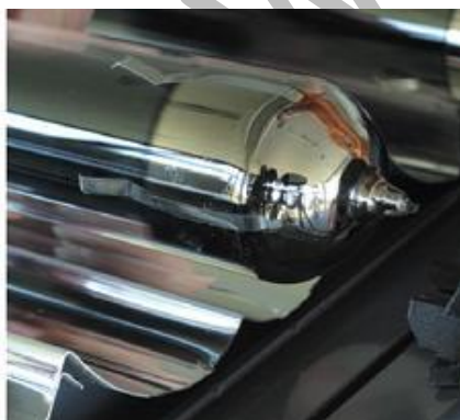
газопоглотитель в порядке, трубка исправная
