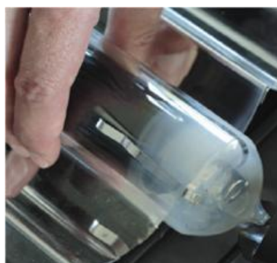
газопоглотитель разрушен, трубка неисправная
