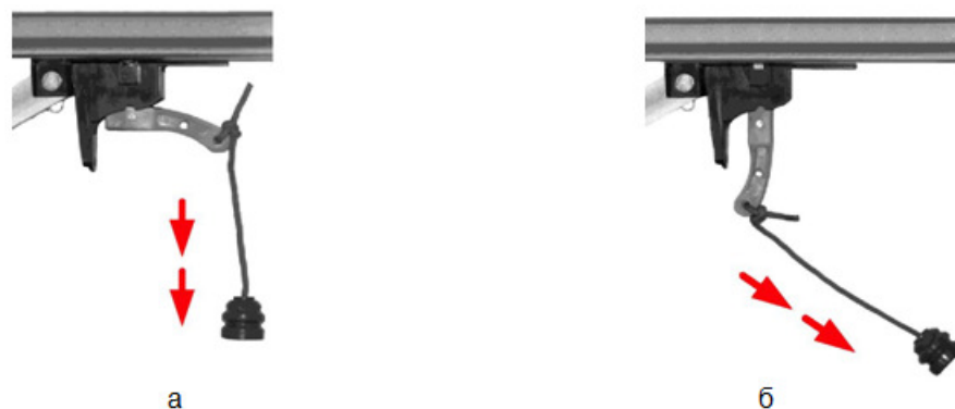
Рис. 3. Ручная разблокировка каретки
