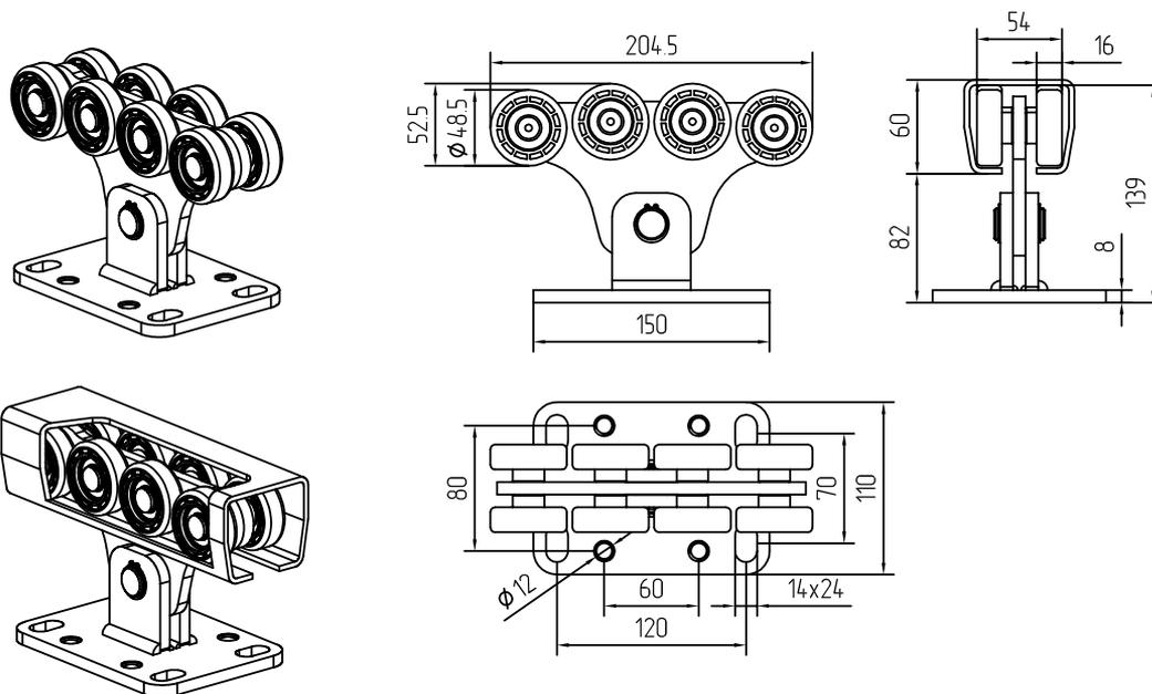
Опора роликовая с роликами из высокопрочного полимера предназначена для перемещения створки самонесущих откатных ворот. Используется для изготовления ворот на шине SG.01.x. Для регулировки опоры по высоте рекомендуется применять болты M12x50 DIN933 оцинкованные.
