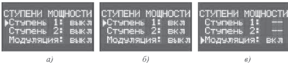
Малюнок 14.45 - Розділ Конфігурація: а - обидва ступені нагріву і модуляція виключені; б - обидва ступені нагріву включені; в - включена модуляція
