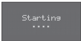
Малюнок 14.3 – Повідомлення про початок запуску котла
