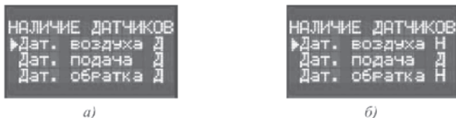
Малюнок 14.43 - Розділ Блокування: а - всі датчики активні; б - датчики повітря і обратки заблоковані
