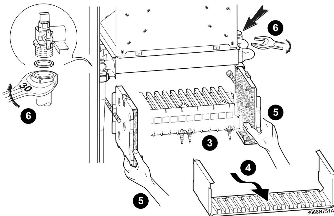
4 Снять противоизлучающую пластину.
