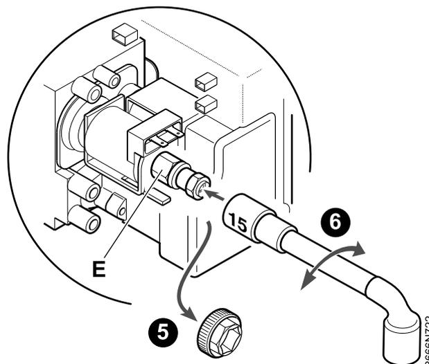
**5** Снять красное кольцо исполнительного механизма модуляции.
