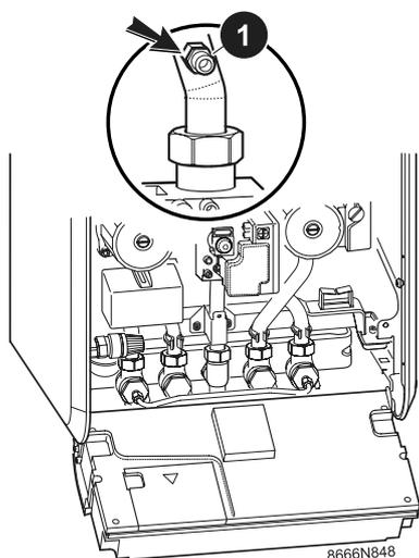
❶ Отвернуть на несколько оборотов винт внутри отвода для измерения давления на горелке.
