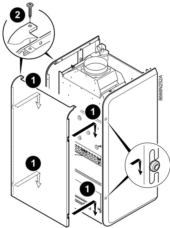
**i** Установка передней панели обшивки должна выполняться после ввода в эксплуатацию.
