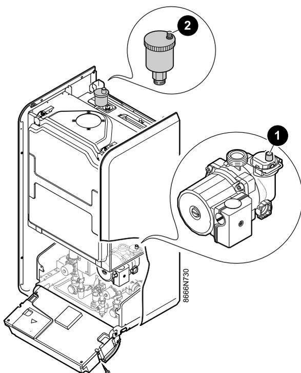
**1** Отвернуть на 1/4 оборота колпачок автоматического воздухоотводчика, расположенного на корпусе циркуляционного насоса.
