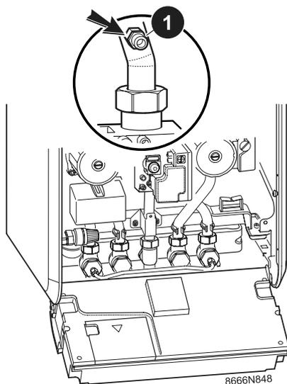
**!** Отсоединить манометр. Завернуть винт отвода для измерения давления. Выполнить контроль герметичности газа.
