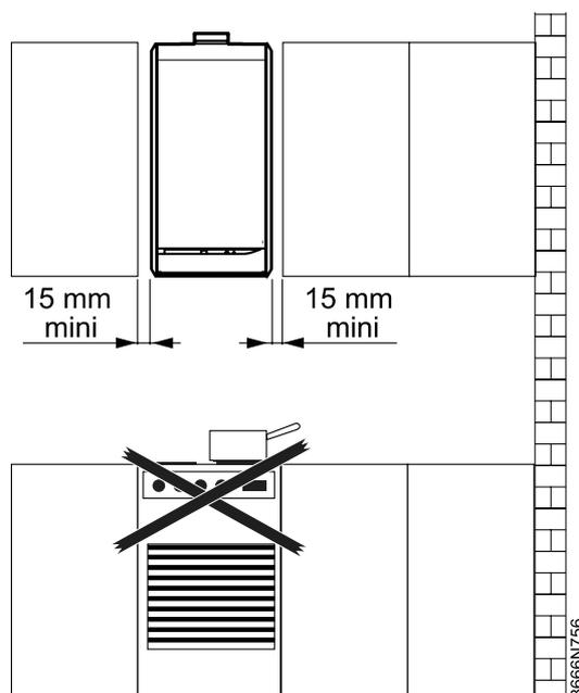
**⚠ Котел не должен быть установлен над источником теплоты или варочным оборудованием**
