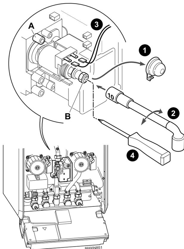
**1** Снять защитный колпачок.
