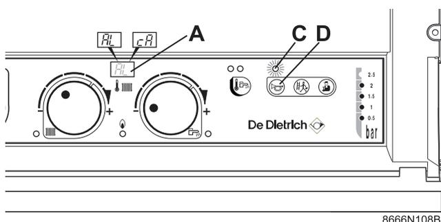
▶ Для зажженной горелки спровоцировать отключение газа, закрыв запорный кран.
