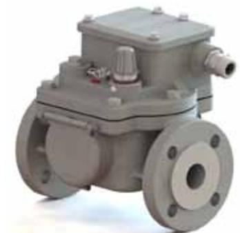
Струйный масляный сигнализатор представляет собой защитное реле для контроля циркуляционной системы масляной смазки или масляного охлаждения в машинных установках и трансформаторах. Его задача состоит в сообщении о неполадках в циркуляционной системе масла в случае их появления или же в отключении установки и предотвращении таким образом ее повреждения.
