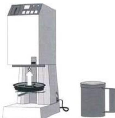
Теперь поместите собранный комплект из ножа и разбрзгивающего устройства наверх до полного упора,стыковки со спиралеобразным зубчатым соединительным элементом. Собранный комплект захвачен (свачен) магнитом, который удерживает надежно (крепко) его вместе с разбрзгивающим устройством.
