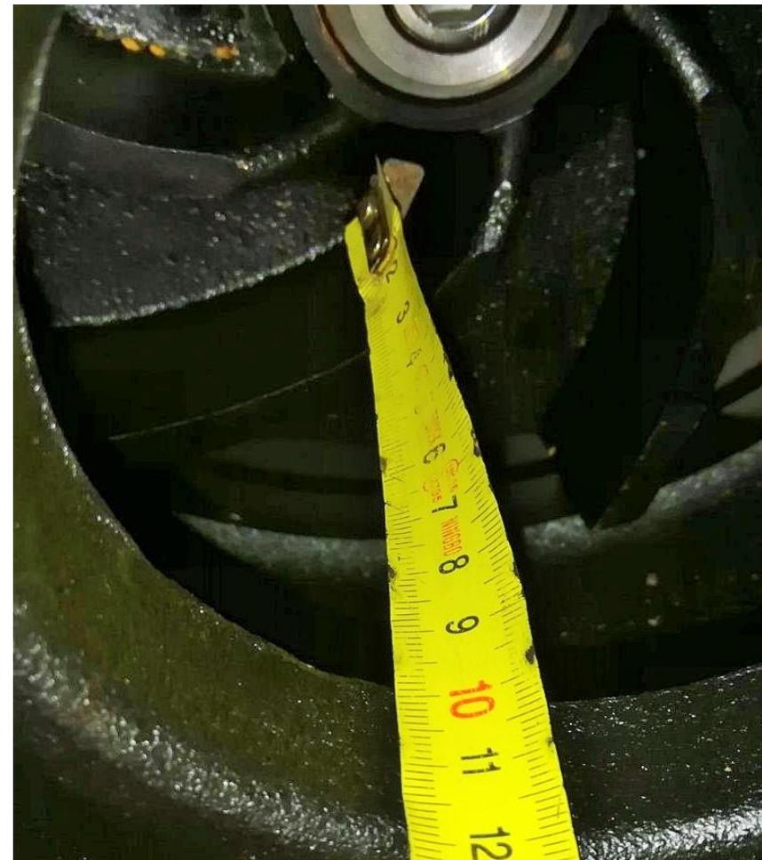
Болт фиксации рабочего колеса из нерж.стали ,
