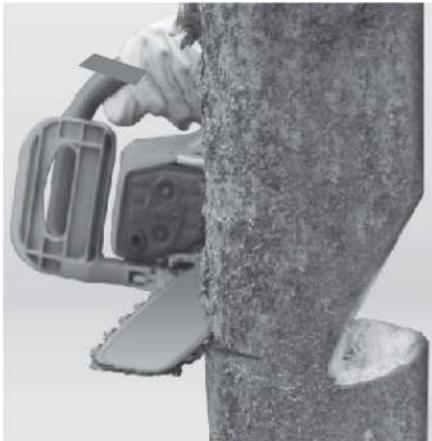
Виберіть напрямлення валки дерева. З того боку зробіть клиноподібний пропил висотою не більше 10 сантиметрів. Після чого зробіть горизонтальний проріз на протилежній стороні дерева. Не прорізайте дерево до кінця, залиште середину, це дозволить Вам керувати падінням дерева.
