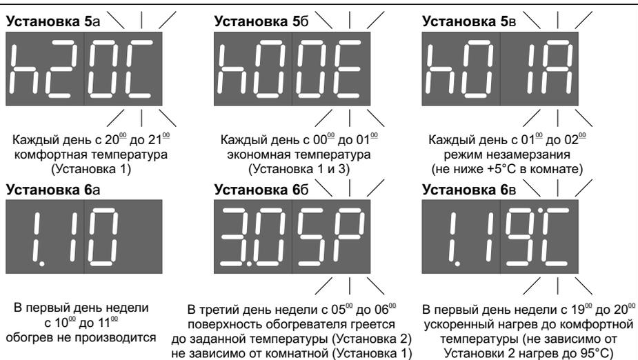
**Рис.3 Программирование режимов обогрева (примеры)**
