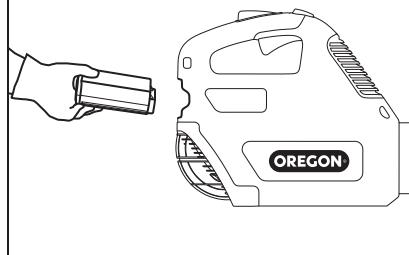
Para extraer el módulo de la batería, levante la liberación de la batería, sujeté los laterales del módulo de la batería y extráigalo (Fig. 10).
