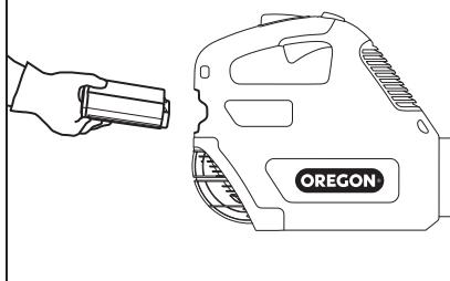
Para remover a bateria, levante a alavanca de liberação, segure a bateria pelos lados e remova-a (Fig. 10).
