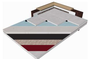
**Устройство холодной кровли:** Sikalastic®-602 BR - 1 слой, армирование нетканым полотном Sika® Reemat Premium и герметизация 1 слоем Sikalastic®-622 TR или 2 слоями Sikalastic®-623 DR
