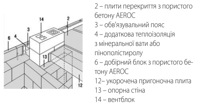
Влаштування отвору для монтажу вентканалу в перекриттях AEROC
