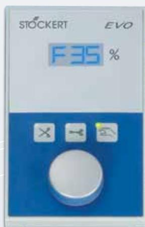
В соответствии с концепциями безопасности венозная линия пережимается одновременно с остановкой артериального насоса, произошедшей по тем или иным причинам (срабатывание систем безопасности, ручное отключение). После возобновления работы артериального насоса электронный венозный зажим открывает просвет венозной магистрали на ранее заданный размер. Существует возможность временного отключения функции автоматического пережатия венозной магистрали.
