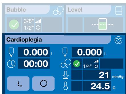
Блок служит для управления одинарным или сдвоенным насосом при проведении кристаллоидной или кровяной кардиopleгии. Перфузиолог может выбрать ручной или автоматический режим введения.
