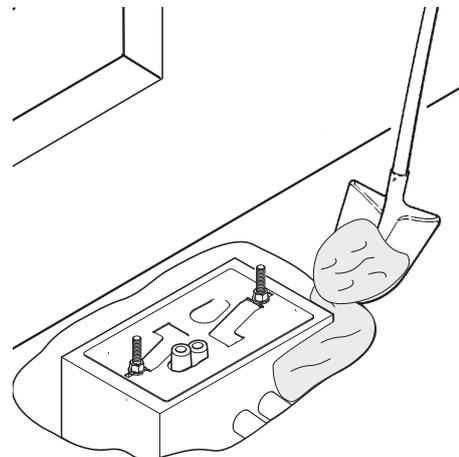
Відкрутіть гайки з гвинтів.
