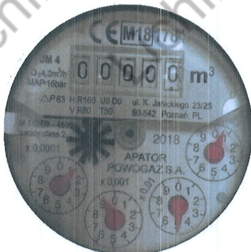
Рисунок 10 – Маркування показувального пристрою малого лічильника модифікації JM...
