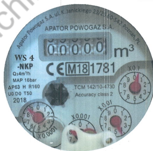
Рисунок 11 – Маркування показувального пристрою малого лічильника модифікації WS...
