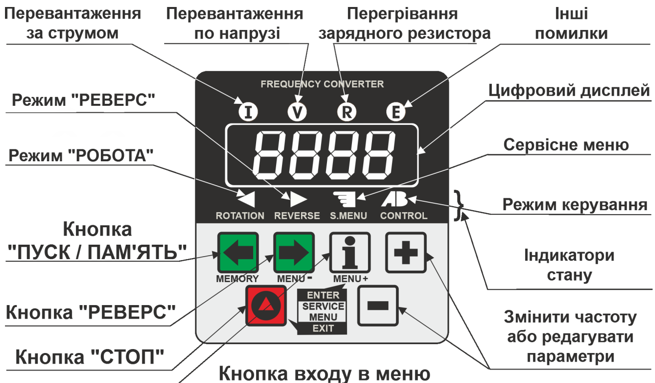
Рисунок 4. Зовнішній вигляд панелі керування.
