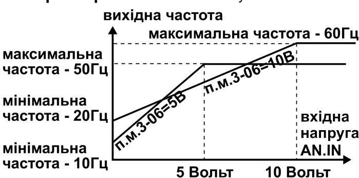
Рисунок 13. Масштабування AN.IN по верхній межі діапазону сигналу.
