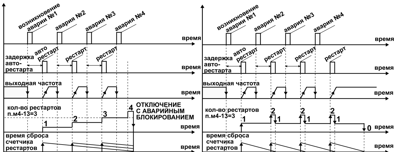
Рисунок 20. а) Превышение допустимого количества автоматических рестартов при возникновении аварий в ПЧ.
