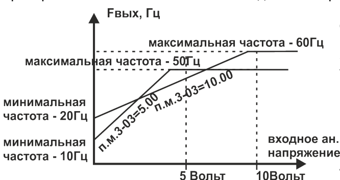
Рисунок 14. Зависимость частоты от уровня сигнала аналогового входа.
