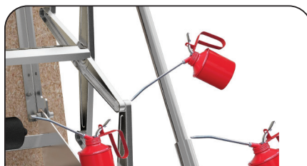
2.7 Si consiglia la lubrificazione con olio singer o similari ogni 12 mesi.
