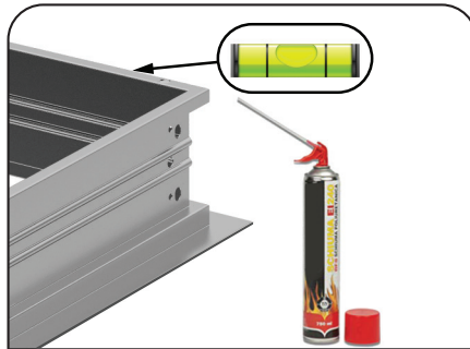
2.4 Assicurarsi che il nervo-telaio sia in bolla! Utilizzare schiuma poliuretana.
