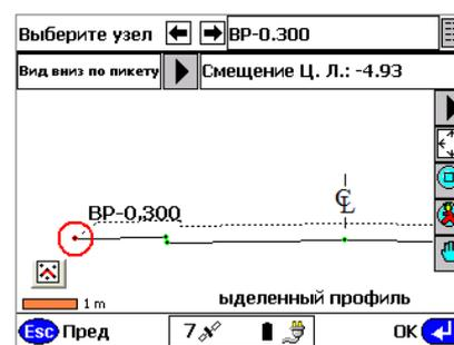
При применении поправки основания она отображается в режиме вида профиля (как показано на Рис. 1.10). Сплошная линия представляет разбиваемую поверхность – в данном случае при помощи поправки основания. Пунктирная линия представляет опорную поверхность или модель окончательного уровня проекта. Значок слева от поля «Проект.отм.» указывает, что поправка основания применена в текущий момент.
