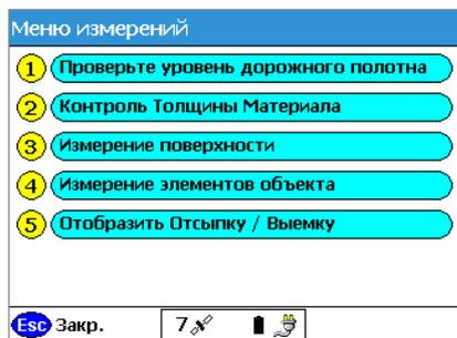
**Примечание.** – Опция «Контроль уровня» означает наличие модели дороги, а не модели поверхности. Она действует в основном также как стандартная опция «Контроль Уровня Поверхности» с тем различием, что исходная модель представляет собой модель дороги Terramodel.
