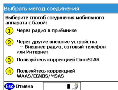
Программное обеспечение настроит подвижный приемник для поиска и отслеживания сигнала OmniSTAR.
