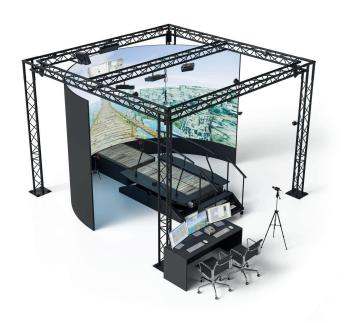
GRAIL Является комплексным решением для анализа и обучения ходьбы, интерактивная лаборатория GRAIL (Gait Realtime Analysis Interactive Lab «Интерактивная лаборатория анализа в режиме реального времени») использует инструментальную двухполосную беговую дорожку - систему захвата движения в сочетании с виртуальной реальностью и видеокамерами. Все показатели ходьбы доступны в режиме реального времени для анализа и тренировок. Полный клинический 3D-анализ множественных циклов ходьбы всего.
