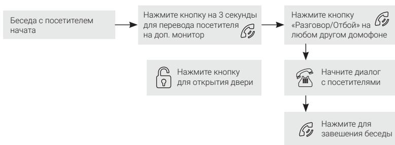
Если пользователь не нажмет кнопку «Разговор» на другом мониторе (например, не успеет к нему подойти в течение минуты), то, после переадресации вызова на другой монитор, мелодия вызова будет звучать в течение интервала длительности, заданного в меню этого монитора (от 5 до 45 с). Затем на экране останется изображение от используемой в данный момент панели до тех пор, пока общее время с начала переадресации не достигнет 60 с, а затем монитор перейдет в режим ожидания (экран погаснет).
