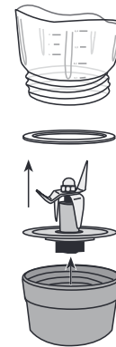
Rimozione blocco lama
