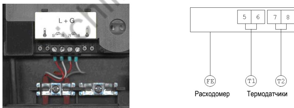
Рис.5 Схема электрических подключений термодатчиков. Т1 – термодатчик сопротивления на подающем трубопроводе; Т2 – то же, на обратном трубопроводе.
