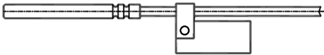
a) Внешний вид термопреобразователя типа PL
