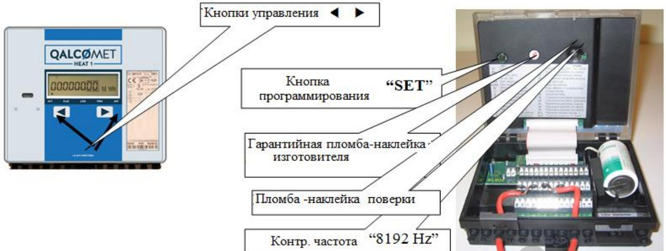
**Рис.7.1.** Общий вид вычислителя.
