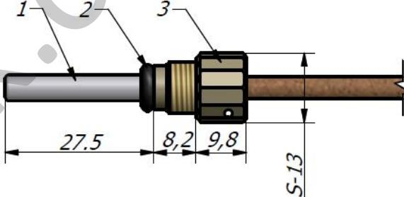
в) размеры термопреобразователя ТР комплекте с гайкой
