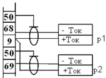
а) двухпроводная схема подключения датчиков давления (4-20mA), питание от вычислителя (+18 В)
