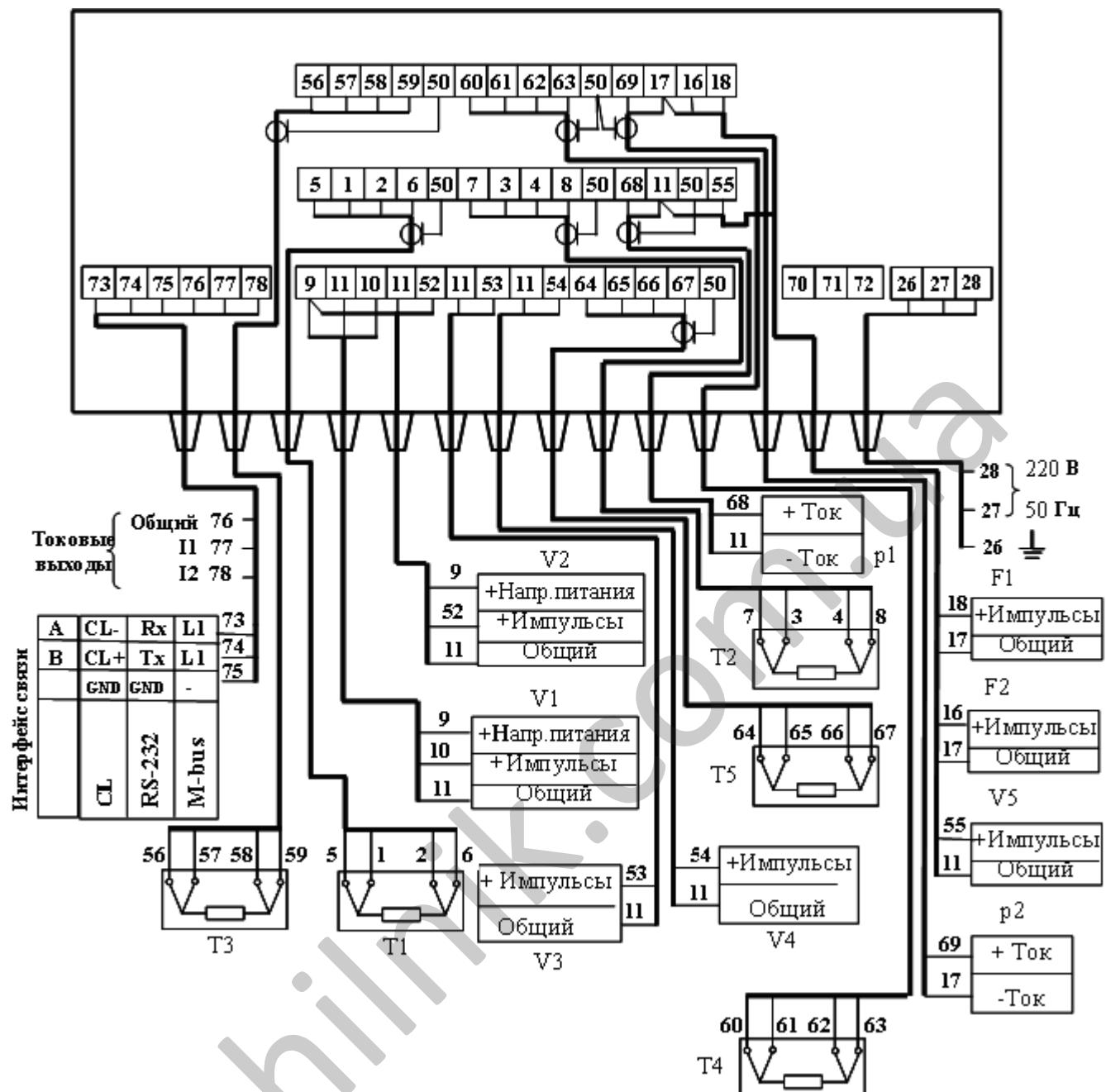
Рис. В1а. Схема монтажа теплосчетчика
