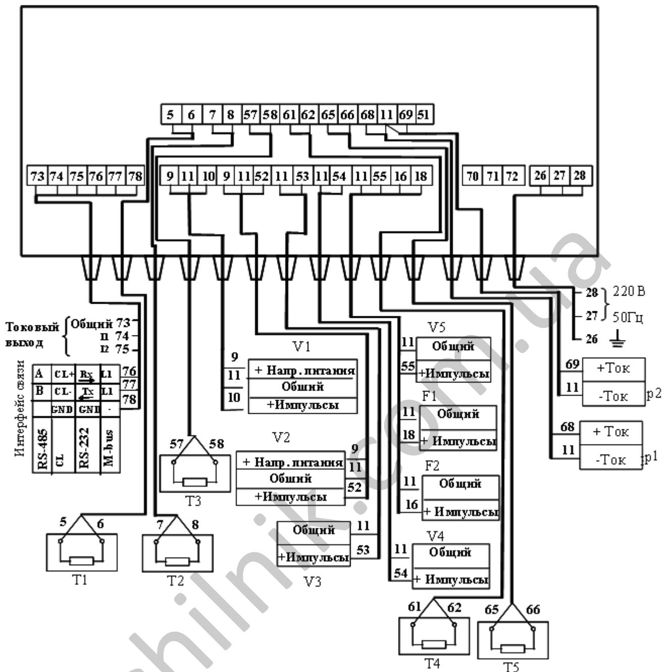
Рис.В16. Схема монтажа теплосчетчика
