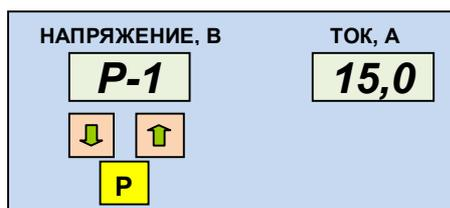
Здесь и далее, во время отображения параметра, кнопками ↓ и ↑ установите значение параметра P1. Пределы изменения тока УЗПС 24-15 от 0,5 А до 15 А, УЗПС 24-25 – от 0,5 А до 25 А. После ввода параметра P1 нажмите кнопку «P» и перейдите к вводу параметра P2.
