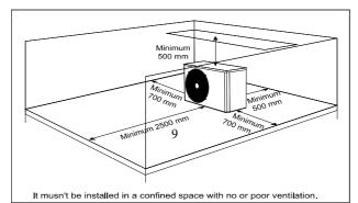
обслуживания. Минимальное расстояние 500 мм от стен, кустарников, оборудования и т.д. со всех сторон насоса обеспечит достаточный доступ воздуха. Для предотвращения рециркуляции воздуха требуется зазор не менее 2500 мм. Не рекомендуется размещать устройство под навесом или настилом, так как это вызывает рециркуляцию выпускаемого воздуха, вследствие чего эффективность обогревателя будет снижена или даже остановлена. Пожалуйста, обратитесь к следующей иллюстрации:
