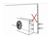
подверженной коррозии конструкции, способной выдержать вес теплового насоса. Он должен крепиться бролтами (М10) к бетонному фундаменту. Внимание!!! Не устанавливайте тепловой насос близко к стене или растениям. И at least 5 НИКОГДА в закрытом помещении! !!Внимание: Запрещается подвешивать агрегат на стену с помощью мягкой трубы, поскольку at least 500mm входное / выходное соединение не выдержит его вес. at least 500mm Соединение должно быть выполнено с помощбю жесткой at least 500mm трубы!
