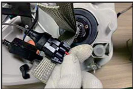
Встановіть лампу в перехідне кільце. В перехідному кільці є спеціальні пази, в які вставляються фіксатори на лампі. Під'єднайте роз'єм живлення лампи до роз'єму живлення штатної лампи автомобіля.
