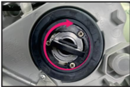
Від'єднайте перехідне кільце від лампи, і встановіть в нижню частину кільця спеціальний ключ.
