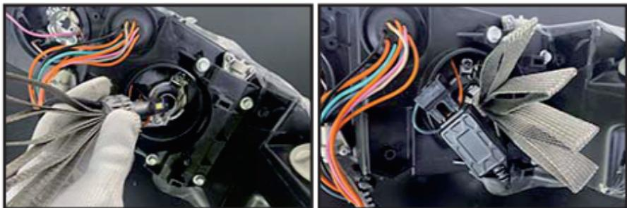
Встановіть лампу в перехідне кільце. В перехідному кільці є спеціальні пази, в які вставляються фіксатори на лампі. Під'єднайте роз'єм живлення лампи до роз'єму живлення штатної лампи автомобіля.
