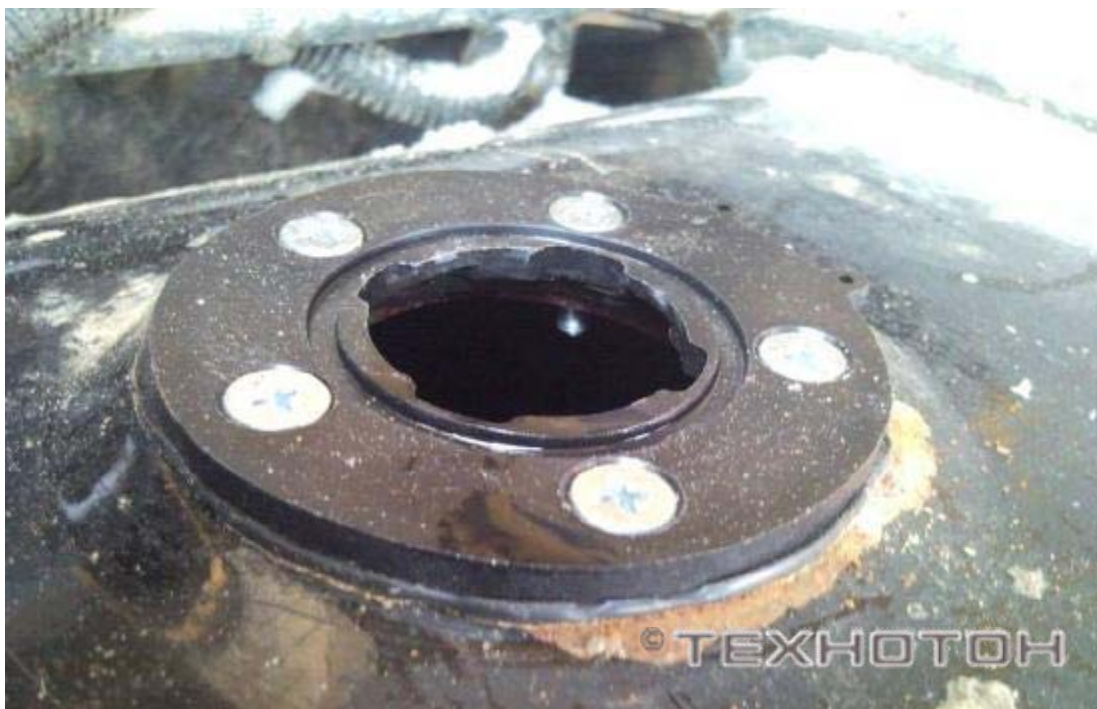
Установка переходной пластины в штатное отверстие
