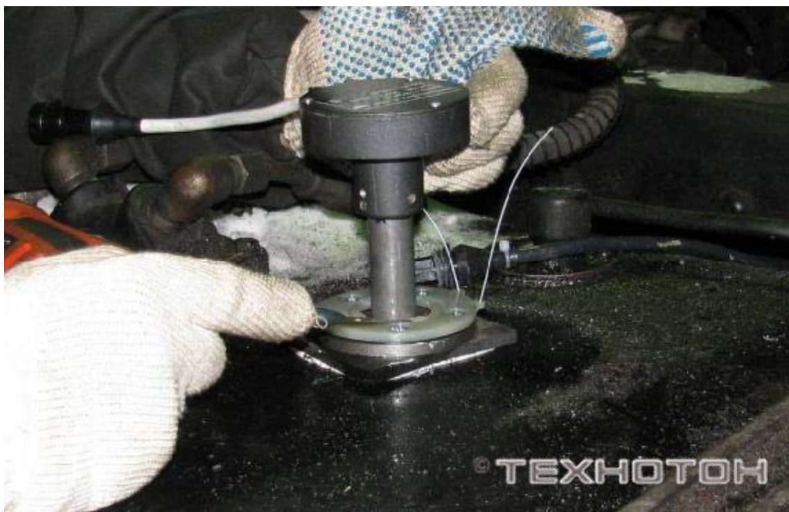
Замер глубины бака
