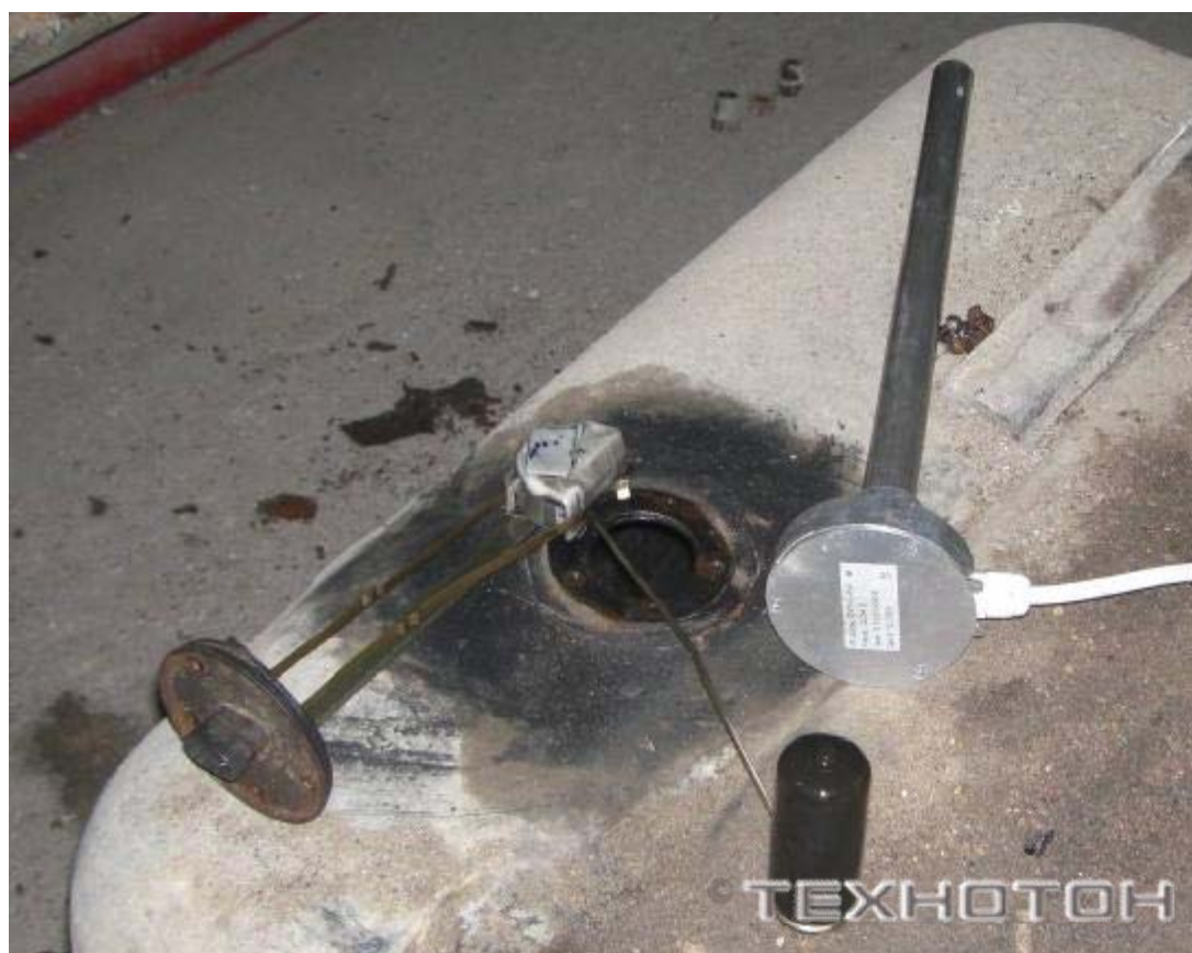
Демонтаж штатного ДУТ
