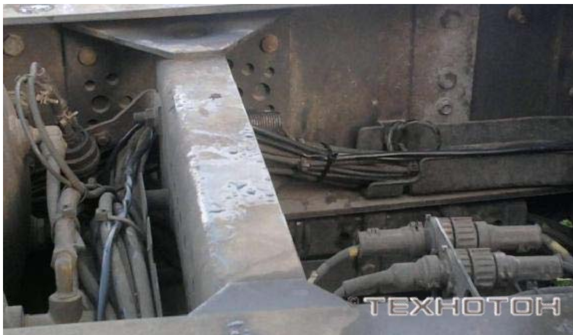
Рис. 6 Укладка сигнального жгута DUT-E
