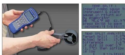
Всього два вимірювання за допомогою Лопастного анемометра дадуть повну інформацію про температуру розділену та фактичну, а також розділити температуру на випарнику і порівняти обидва.
