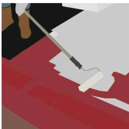
Финишный слой Sikalastic®-621 TC/618 наносится непосредственно на слой Sikalastic®-601 BC/618 по всей площади кровли, включая все детали и примыкания: парапеты, трубы и выступы. Нанесите один или два слоя Sikalastic®-621 TC/618 в зависимости от требований системы SikaRoof® MTC. Материалы имеют контрастные цвета, для контроля качества нанесения.
