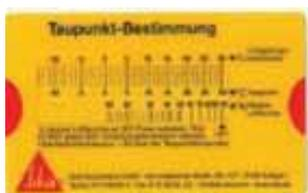
4. Определите температуру конденсации по таблице точек росы или с помощью расчетной линейки Sika.
