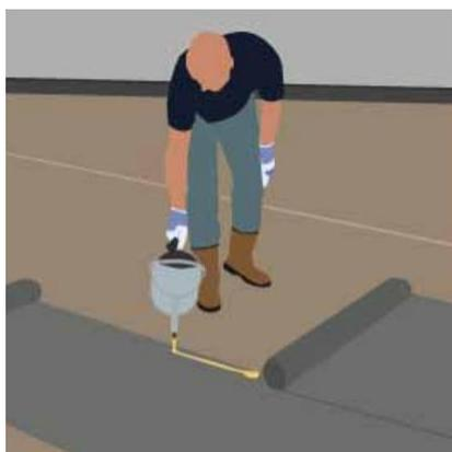
Загерметизируйте боковые и торцевые нахлесты, нанеся полоску клея Sikalastic® Coldstik, и используйте скребок, чтобы удалить и распределить излишек клея.
