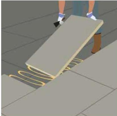
Уложите теплоизоляцию Sikalastic® Insulation на полоски клея Sikalastic® Coldstik и прижмите сверху (встаньте на плиту). Убедитесь, что каждая плита плотно соединена встык со предыдущей и что все швы расположены в шахматном порядке (по типу перевязки кирпичной кладки).
