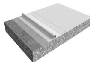
Экономичное решение гидроизоляции кровель для нового строительства и ремонта, при воздействии легкого пешеходного движения.
