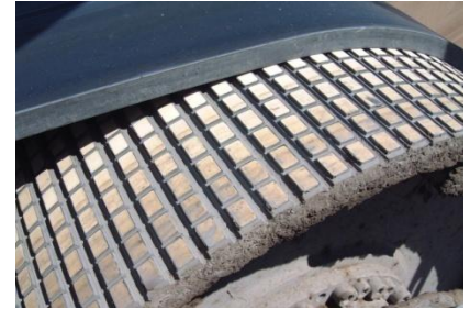
CERASINT футировка на заднем барабане
