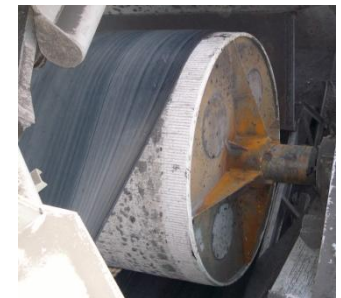
Приводной барабан с футировкой CERADRIVE NORUB
