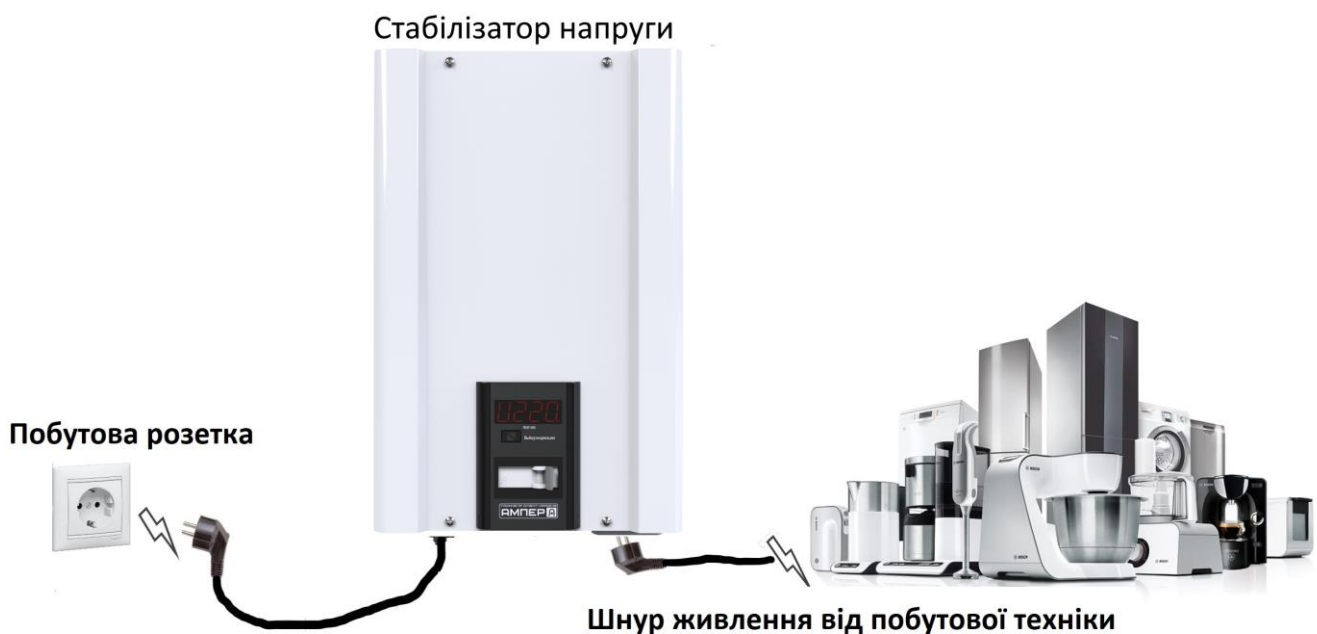
Рисунок 13. Підключення стабілізатора 5-16А до мережі
