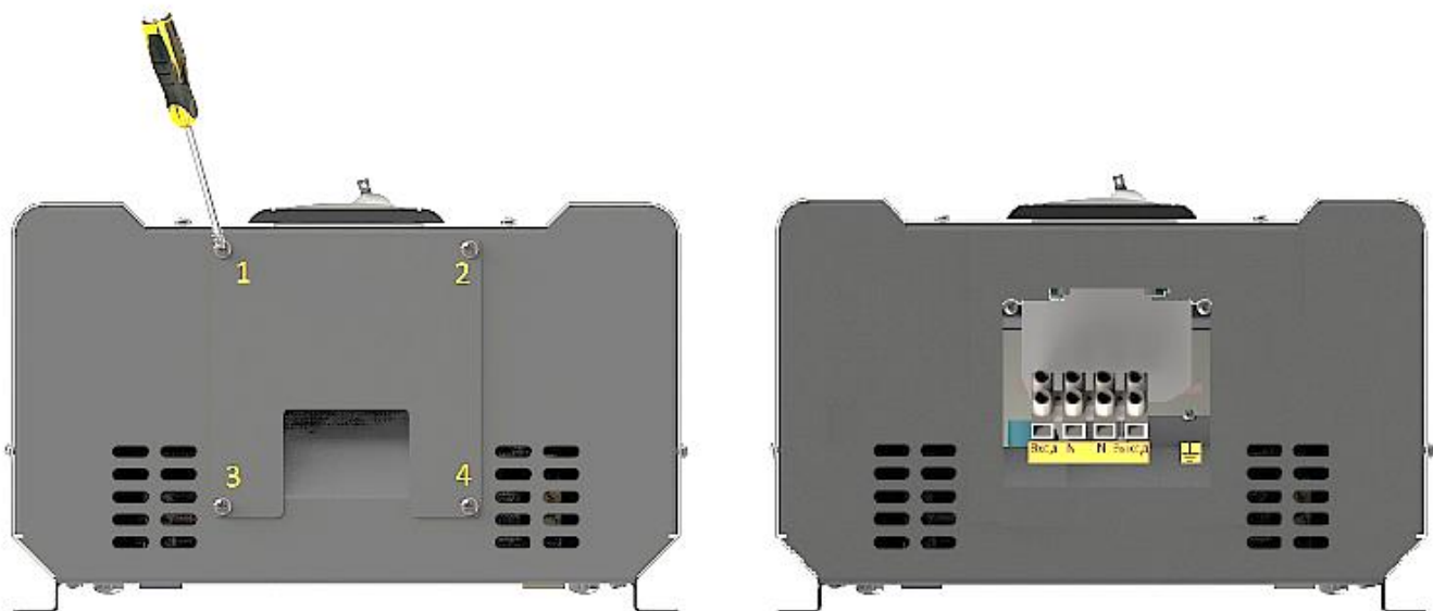
Рисунок 12. Схема зняття захисної кришки знизу корпусу стабілізатора
