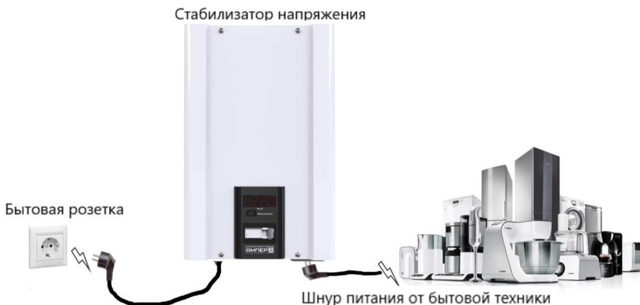
Рисунок 14. Подключение стабилизатора АМПЕР на 5-16А к сети
