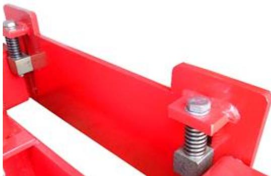
Ролики на пружинах.
