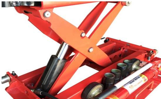
Подъемный механизм ножничного типа. Толщина стали 12 мм.
