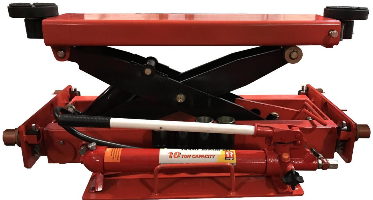
Траверса представляет собой вспомогательное устройство для подъема оси автомобиля, в частности, для выполнения регулировки углов установки колес, замену колес, деталей тормозной системы или любые другие операции, требующие подъема одной из осей автомобиля для обеспечения дополнительного пространства в зоне ремонта. Траверса рассчитана на перемещение вдоль оси канавы и может располагаться в наиболее удобном для слесаря месте.
