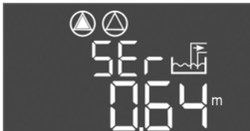
Fig. 72: Індикація інтервалу технічного обслуговування
