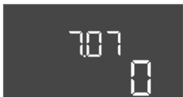
Fig. 73: Увімкнення інтервалу техобслуговування
