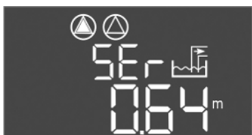
Fig. 72: Techninės priežiūros intervalo rodmuo
