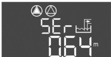
Fig. 72: Afișaj interval de întreținere
