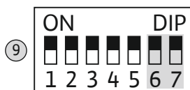
Fig. 10: DIP-вимикач 2: активація насосів
