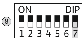
Fig. 16: DIP-вимикач 1: внутрішня звукова сигналізація
