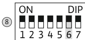
Fig. 17: DIP-вимикач 1: пробний пуск
